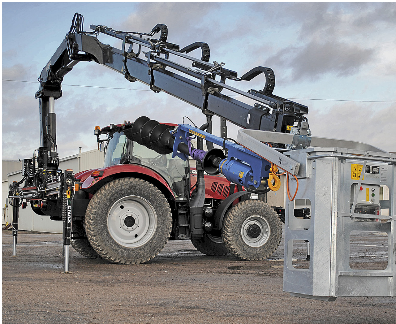
Yksi kuudesta Liettualaiselle sähköyhtiölle toimitetuista JAKE-varustelluista "porakoneista". Balttiassa sähkötolppien istutus tapahtuu kaivamisen sijaan usein poraamalla.
